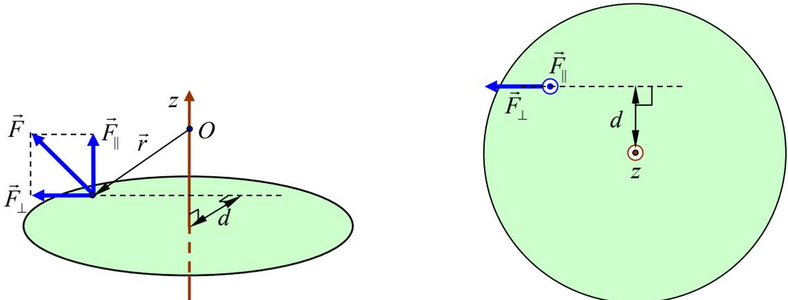
Аналогично момент импульса относительно оси равен произведению импульса  $p_{\perp}$  на плечо  $l$  (рис.):
